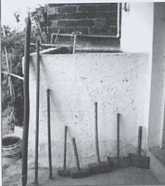
Las herramientas (de izquierda a derecha): barra grande, barretas, dos mandarrias, el marrón y dos escodas
