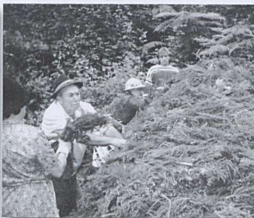
Don Estanislao Hernández Delgado «cargando de leña una hoya de carbón». A la derecha, «poniendo el tapumen de brezo»
