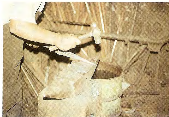
Construcción del regatón.
