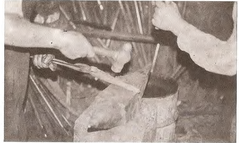
Construcción del Regatón. (Los Llanos de Aridane).
