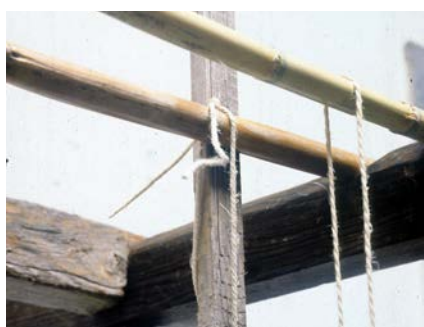
Caña para sujetar el travesaño del peine y los lizos.FUE
