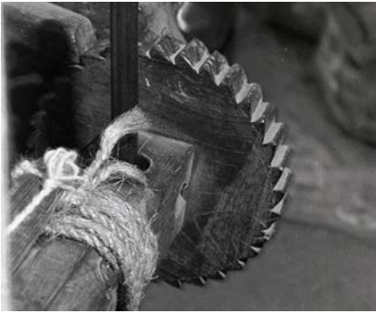
Trinquete del telar de Las Candidas (finales años sesenta, siglo XX). Foto Fachico
