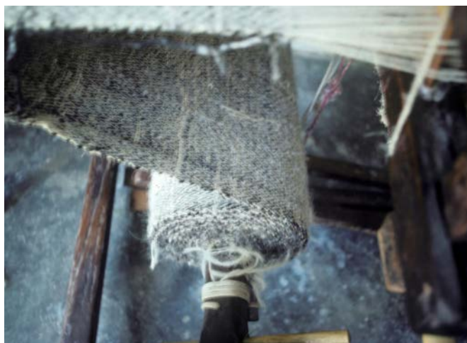
Enjuelo inferior delantero, con tela de lana enrollada. El Hierro
