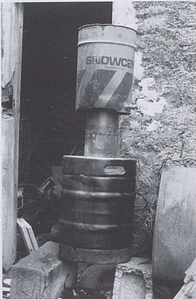
Caldera para destilar agua ardiente (modelo herreño).
