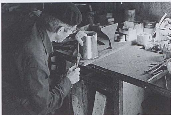
Latonero modelando las chapas de hojalata. Foto: Macarena M. Suárez.
