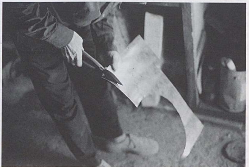
Latonero ejecutando el corte en una chapa de hojalata. Foto: Macarena M. Suárez.
