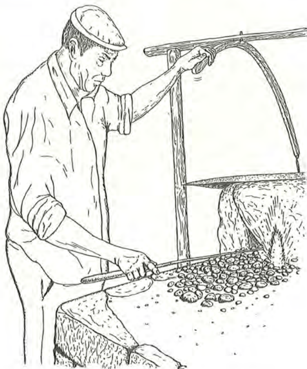
Fig. 17: Accionando el fuelle y atizando el carbón.
