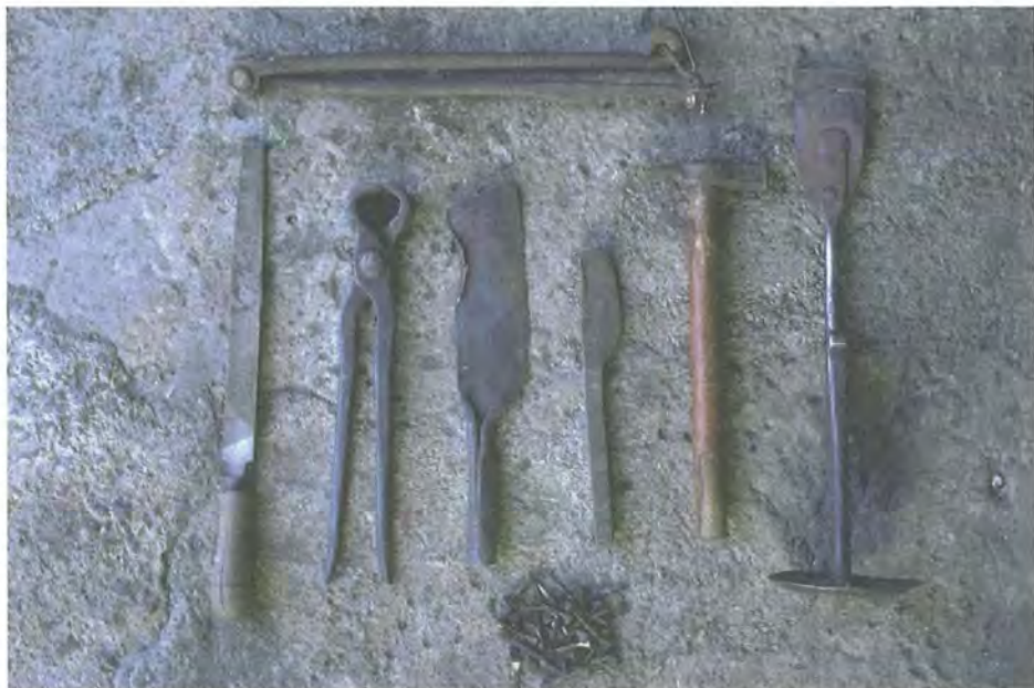
Fig. 16: Herramientas para el herraje.
